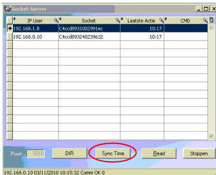
Dans la fenêtre du serveur Socket sélectionnez la pointeuse de laquelle le temps doit être synchronisé, et appuyez sur le bouton "Sync Time". L'heure actuelle du serveur sera envoyée. Cette opération doit être répétée pour chaque pointeuse, dans le cas échéant.
